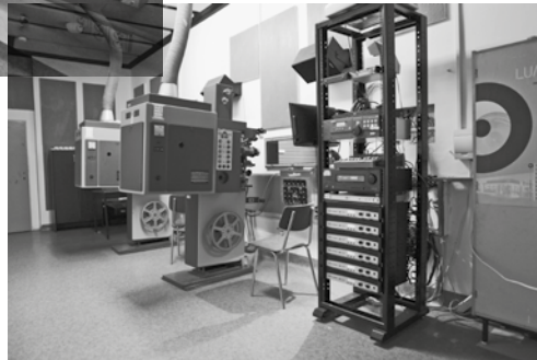
pohľad na kabínu, premietacky, dolby procesor a zvukové zosilňovače
